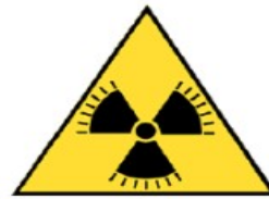
Rischio di irraggiamento
